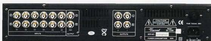
La connectique de haut qualité est dorée 24 k et fait usage d'isolant Téflon. Les sorties doublées facilitent une éventuelle bi-amplification.
