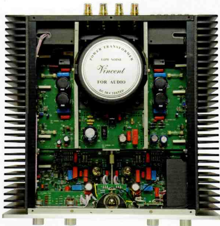
On appréciera la belle implantation véritablement double mono, et la présence d'un transformateur torique totalement blindé.
