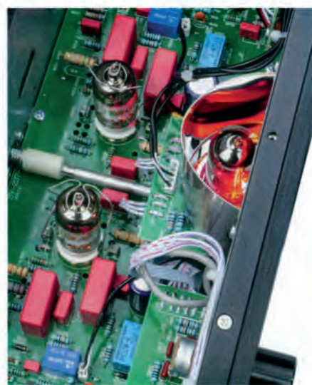
Hier ist das Röhren-Dreigestirn gut zu sehen. Vorn die 12AX7, dahinter die zweite Stufe mit 2x 6BQ7A
